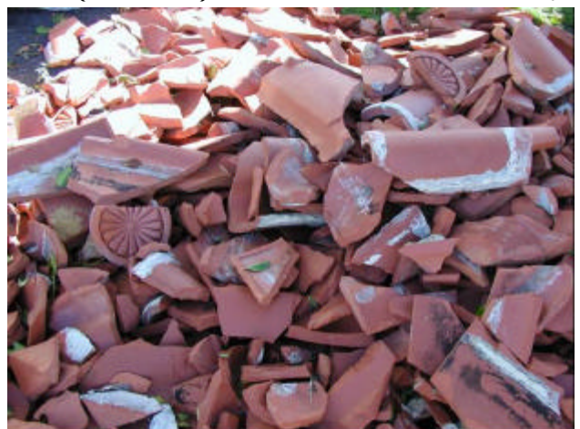
写真 8 破損した屋根ふき材(瓦)
