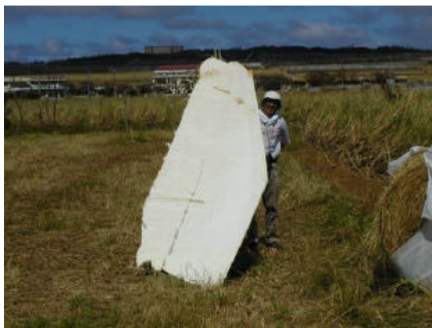
写真 62 ブレード部の飛散
