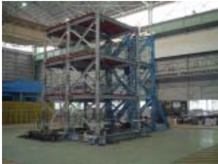
図 2(a) 鉄骨造 3 層試験体 (縮尺 1/2)
