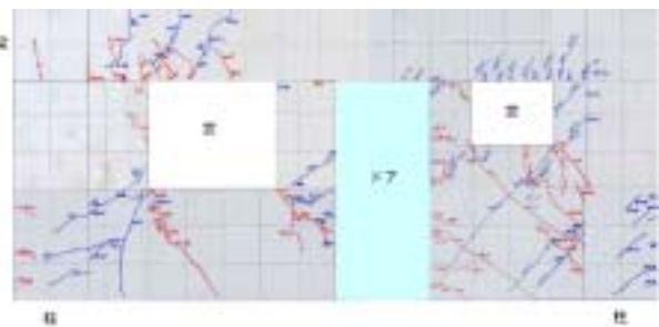
図 6 ひび割れ状況（変形角 1/300）
