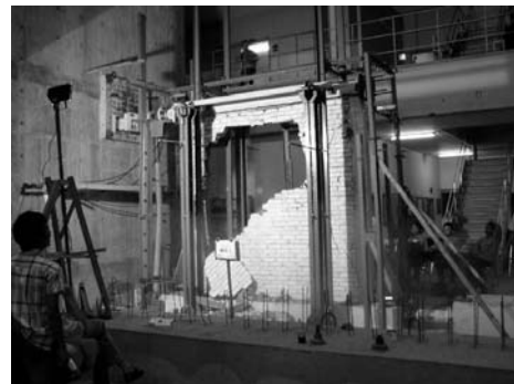
図 2 繰り返し水平加力実験の実施状況
