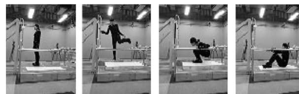
浴槽内立ち座り用水平手すり最適位置と許容範囲
