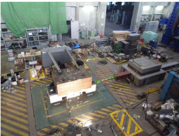
図 1 基礎すべり試験体の震動台実験
