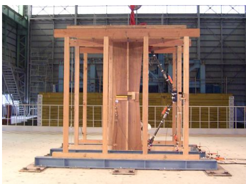
写真2 ダンパをK型に配置した振動台実験用試験体
