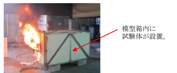
図 2 模型箱試験 試験体: サンドイッチパネル (芯材: ポлистиロミアスルトフォーム)
