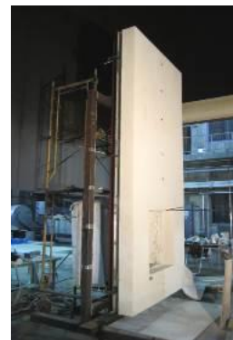
図 5 ファサード試験装置 図 6 ファサード試験の状況
