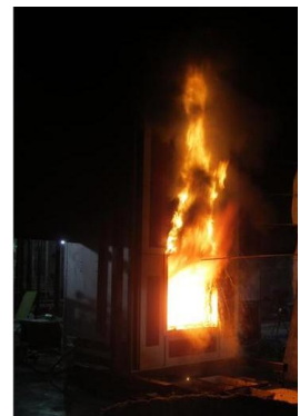
図 5 ファサード試験装置 図 6 ファサード試験の状況
