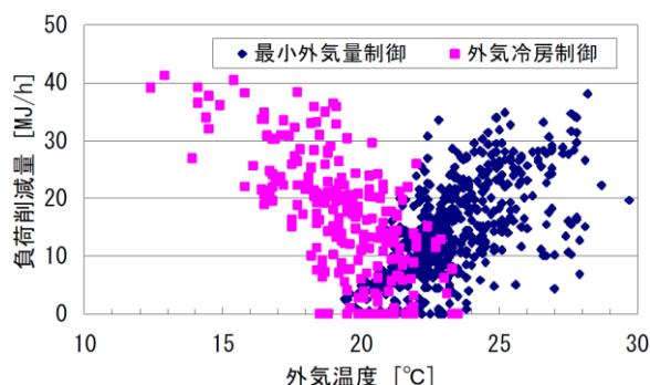
図 1 外気温度と外気負荷削減量の例（事務所、床面積約 10,900m<sup>2</sup>、北海道）
