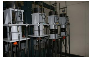
写真 1 クリープ試験の状況
