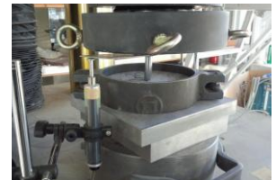
写真 2 耐アルカリ試験の状況
