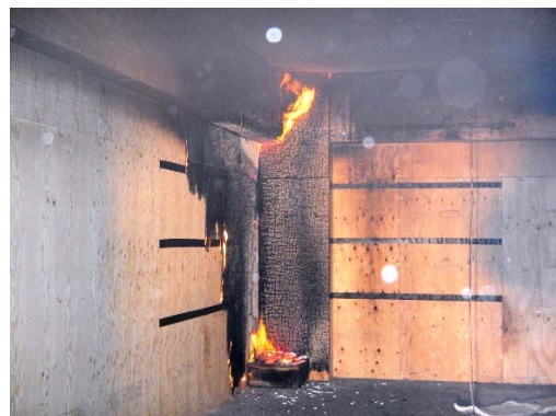
図 1 天井を不燃化した火災実験における木質内装の燃え止まり（既往実験）
