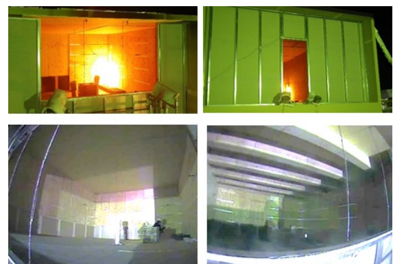
図 5 開口条件や床面積、内装仕上げによるフラッシュオーバー遅延効果を確認する火災実験
