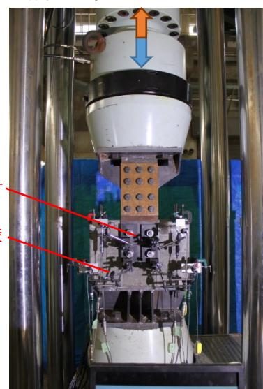
写真 1 RC 造壁部材と鋼部材の接合部要素実験
