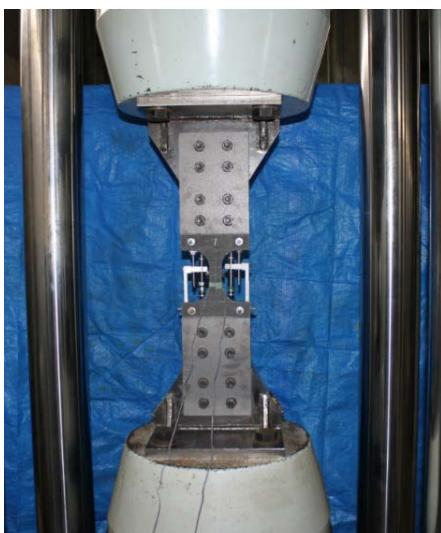
写真2 鋼材ダンパーの要素実験
