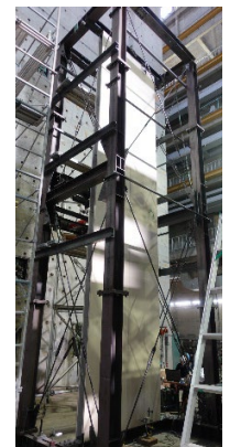
写真 3 高さ 8m の LGS 壁に対する面外載荷実験
