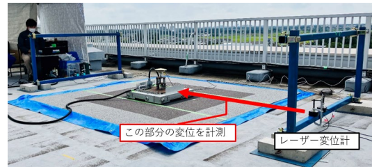
図3 可動式振動台を用いた検証実験
