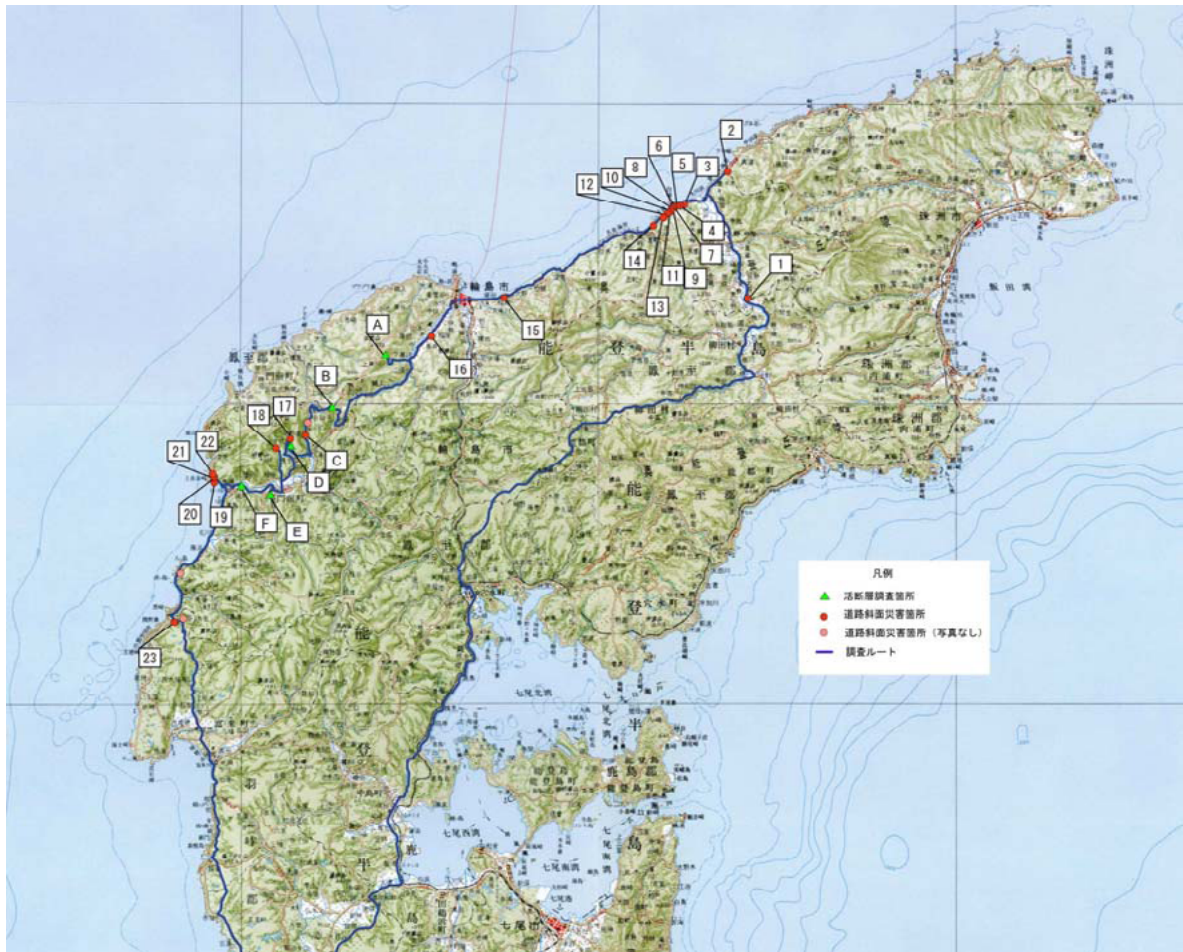
図-2.5 地震断層の疑いのある変状および周辺地域の変状の現地調査地点位置図 (図中のA、B、C、D、E、F)
