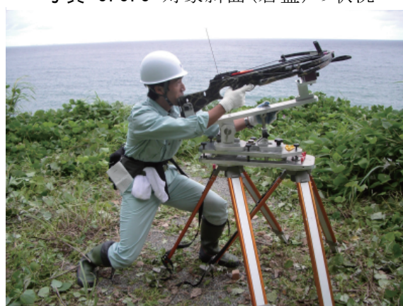
写真-3.3.4 RE・MO・TE 2により標的を設置
