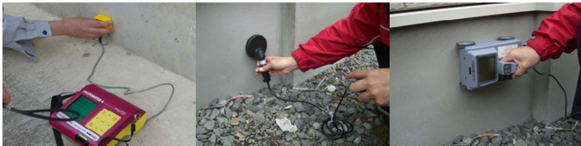
写真-10.6.9 鉄筋計による基礎コンクリートの配筋等の調査
