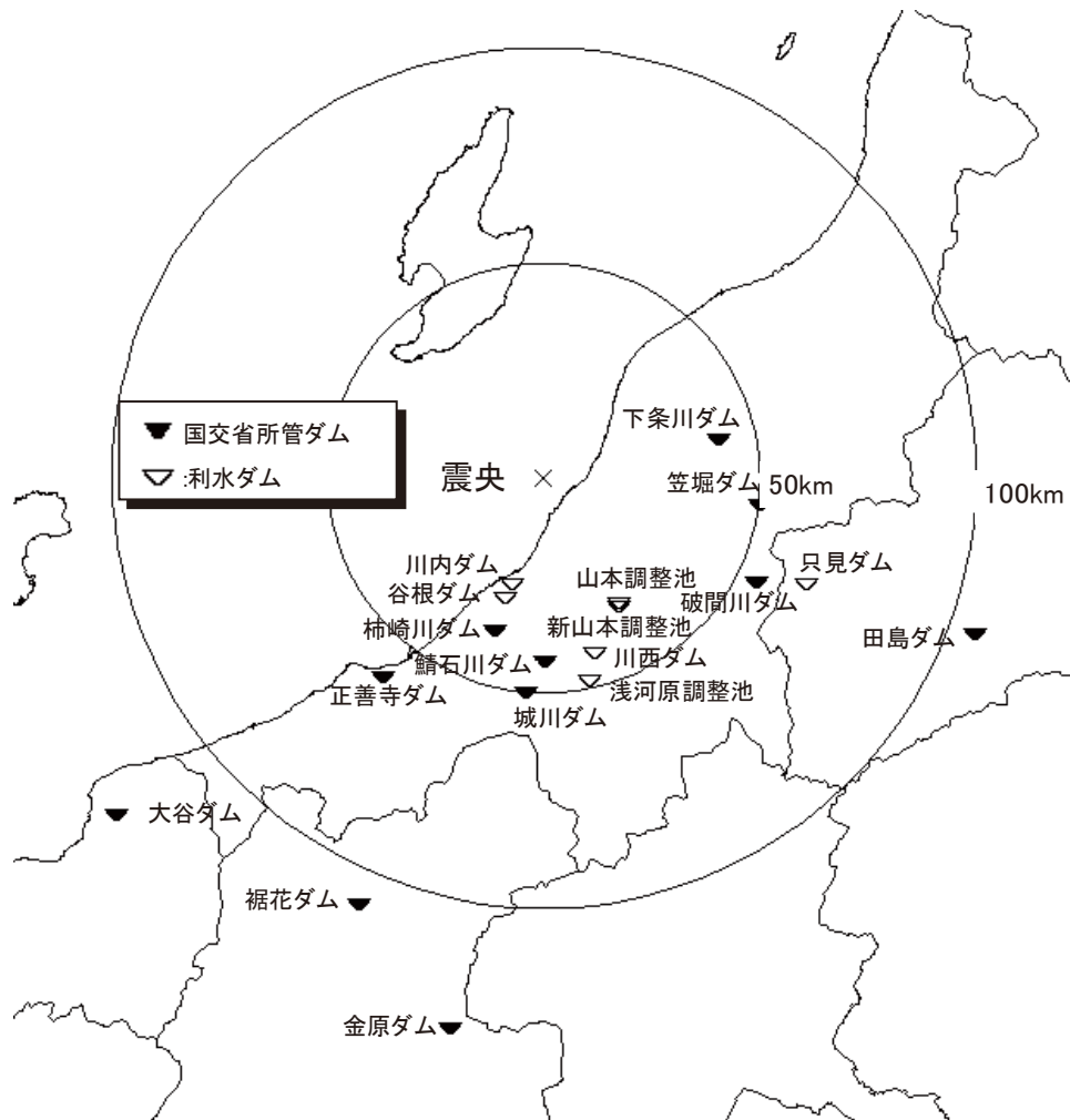
図-6.46 ダム基盤で 25gal 以上を記録したダム
