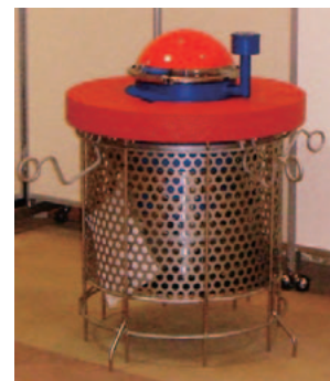
図-3.7.2 投下型水位観測ブイの外観
