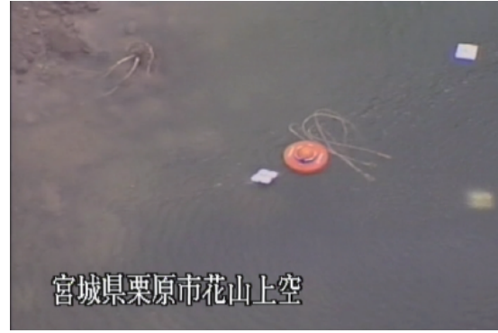
図-3.7.4 設置後のブイ浮上状況
