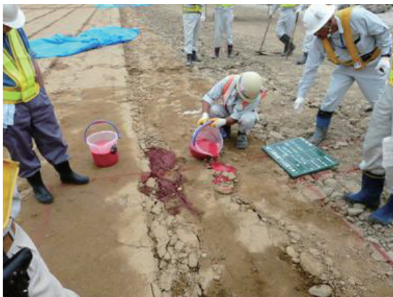
写真-5.10 亀裂深度調査状況 (コア部) (東北地方整備局胆沢ダム 工事事務所提供)
