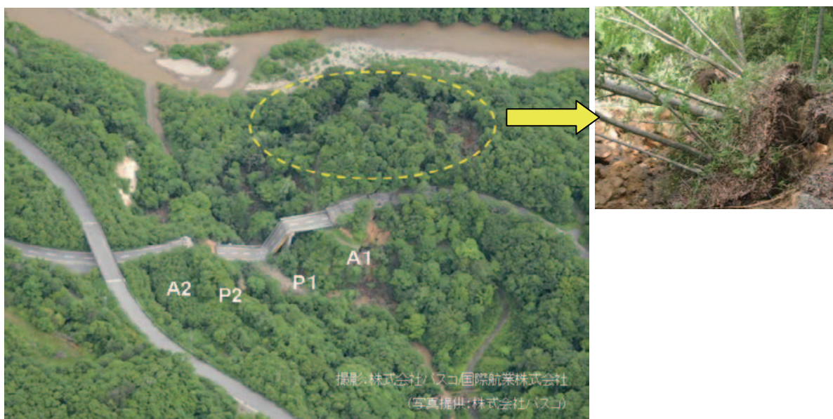
写真-6.24 A1 橋台周辺の地山崩壊（撮影：株式会社パスコ／国際航業株式会社）
