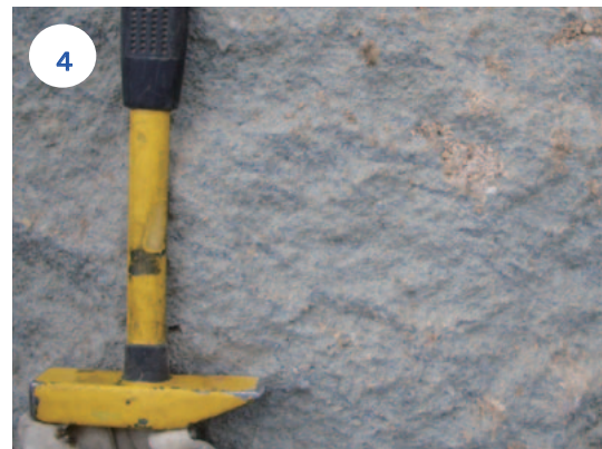
写真-3.4.48 溶結凝灰岩の硬さはハンマーの弱打で濁音を発して割れる程度である。（6月22日撮影）
