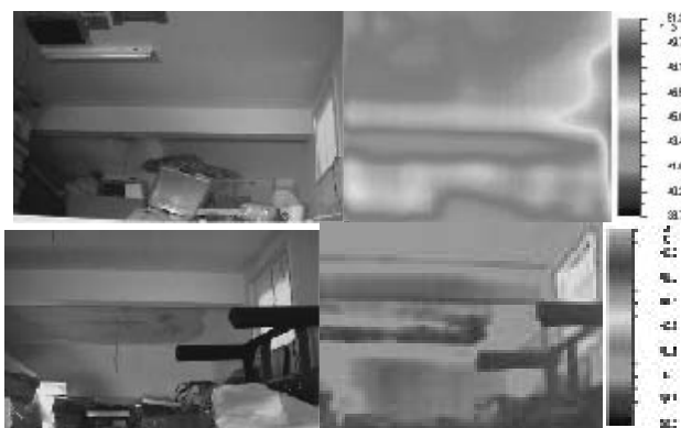
図7 改修前後の天井面の熱画像(上=改修前、下=改修後)
