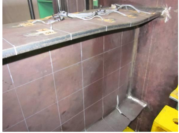
最終破壊状況(+224 サイクル目)
