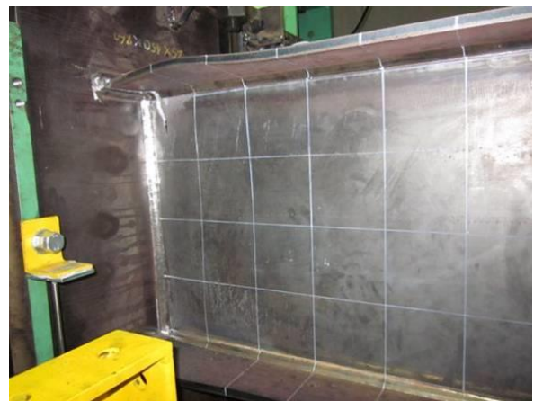
最終破壊状況(-217 サイクル目)
