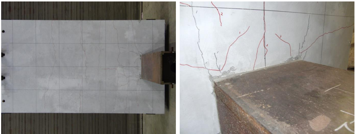
写真 2.3.2-6 最終破壊状況 (G-09-S: +64 サイクル)
