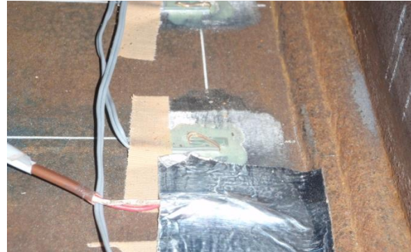
(b) ビード止端部のき裂(5 サイクル)
