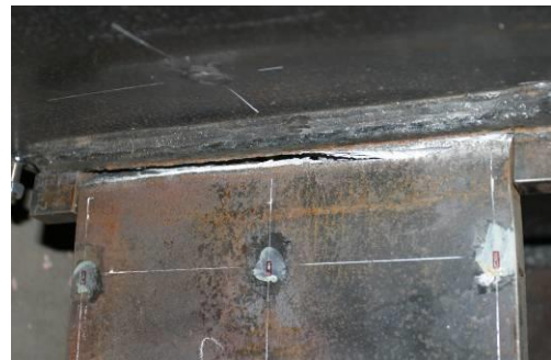
写真 2.5.1-3 破壊状況(試験体 B-A-8)
