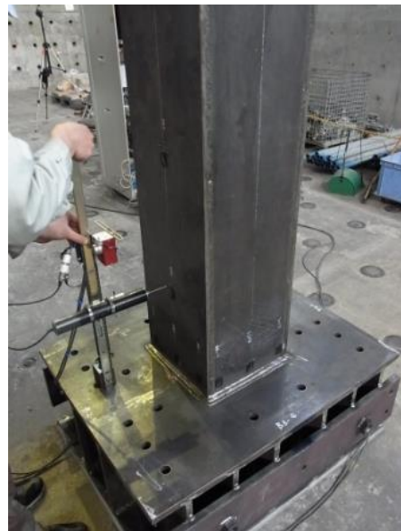
座屈高さ計測状況
