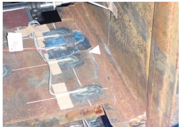
(b) 梁上フランジ溶接ビード止端部のき裂(44 サイクル)
