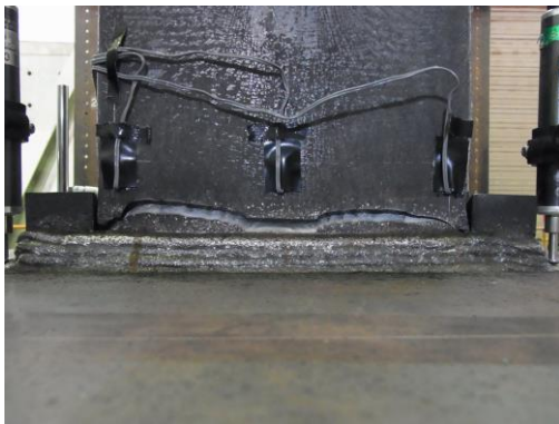
下フランジ破断状況(-20 サイクル)
