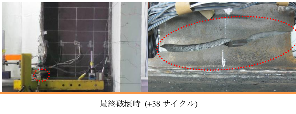
写真 2.2.2-2(f) 破壊状況(試験体 AD-2-S)
