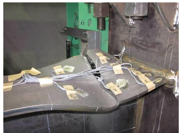
最終破壊状況(-42 サイクル目)
