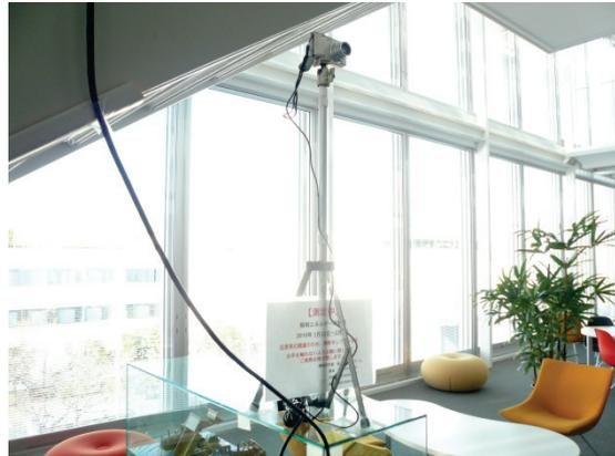
図 V. 2. 2. 20 在室検知用可視画像カメラ
