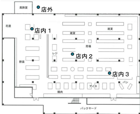
図VI. 3. 5. 14 CO<sub>2</sub> 濃度の計測ポイント
