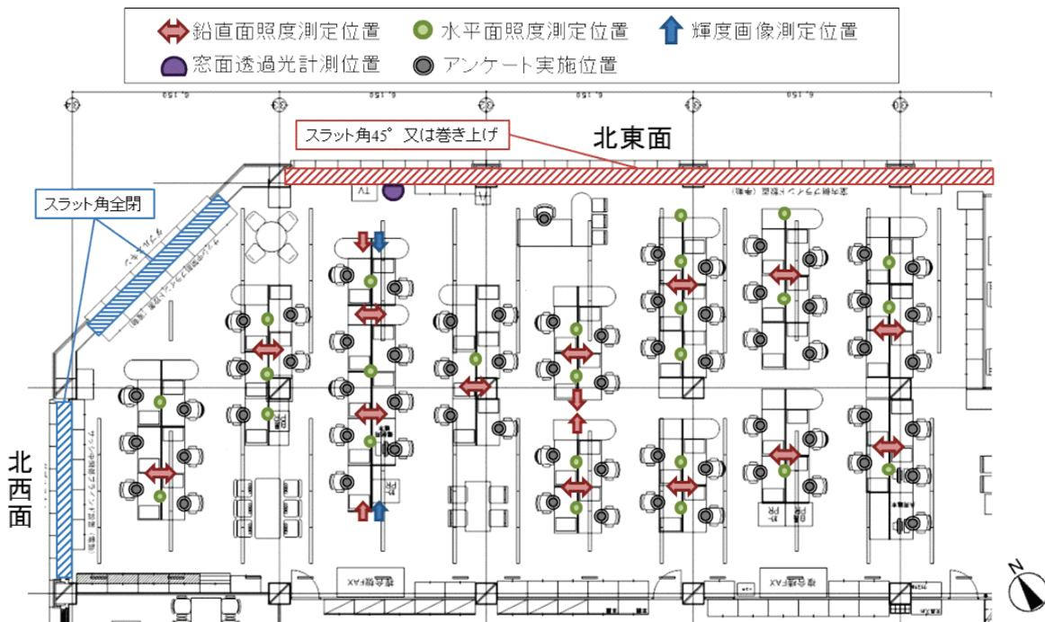
図 V.2.5.7 評価エリア及び計測器設置位置
