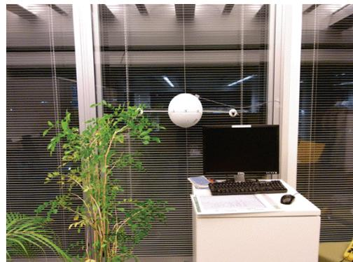
図 V. 2. 2. 17 積分球設置状況
