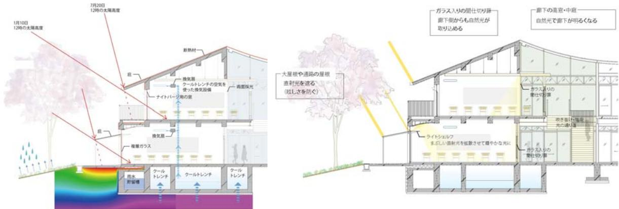
i. 大屋根形状の工夫や高窓・中庭の設置による自然換気
