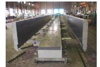
PCa 用型枠（脱型時）
