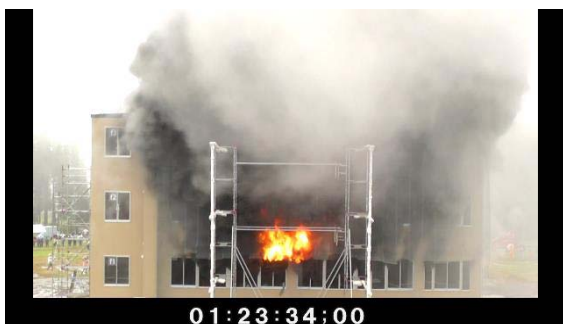
写真 4.7.2-14 北側からの噴出火炎
