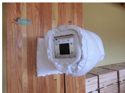
写真 4.5.2-1 建物内撮影用 CCD カメラ（耐熱加工したもの）
