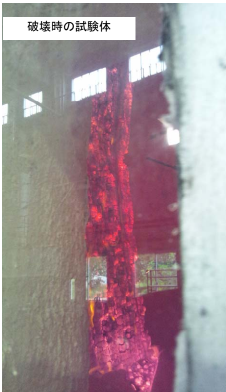
写真 4.7.3-2 柱試験体（両端ピン支持）加熱前・加熱中・加熱後の様子
