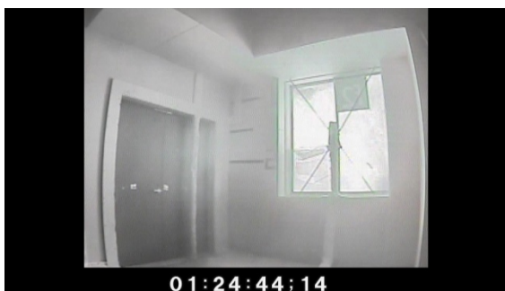
写真 4.7.2-26 ガラス破損時点
