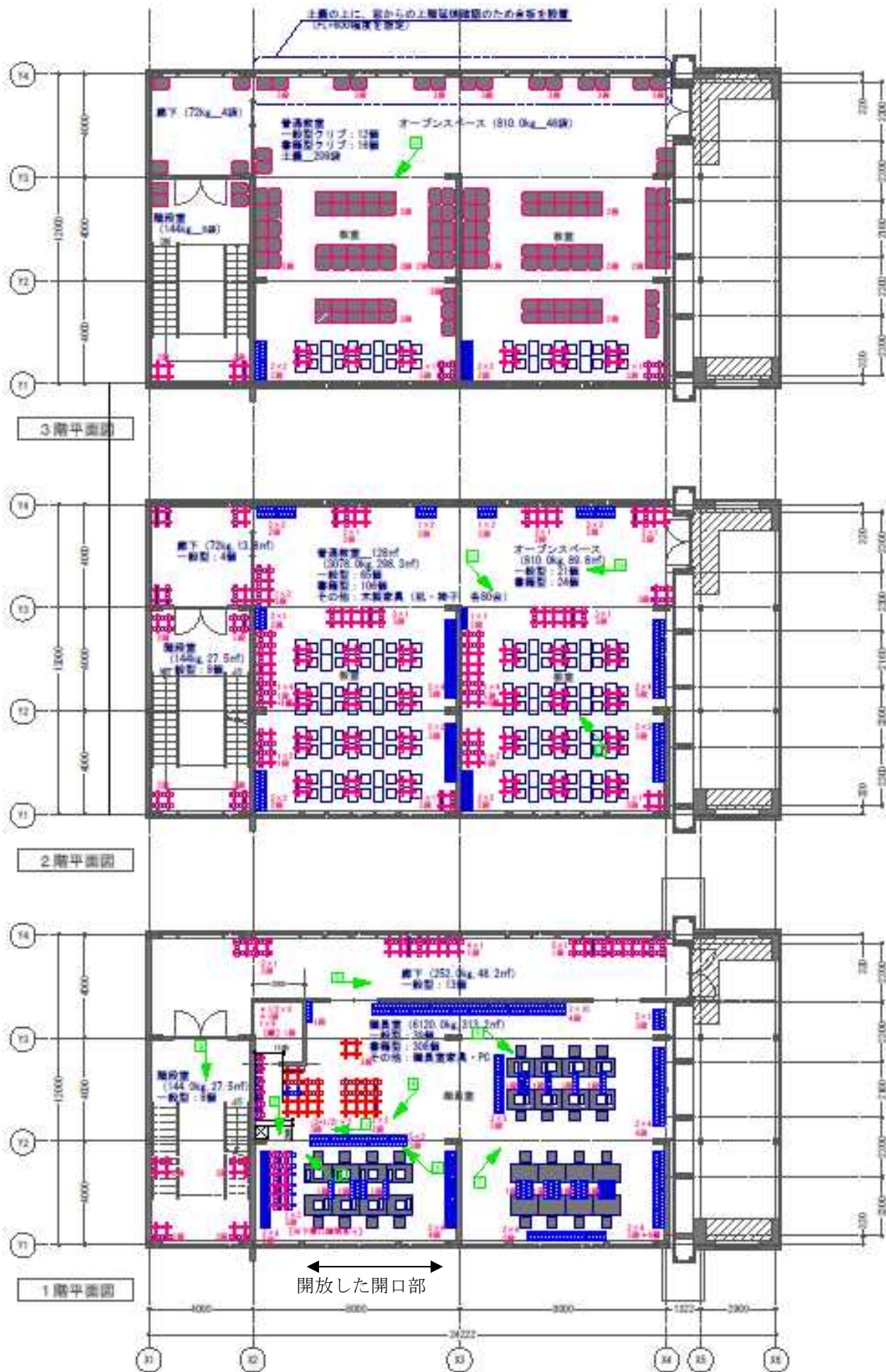
図 4.4.2-1 各室の収納可燃物の配置
