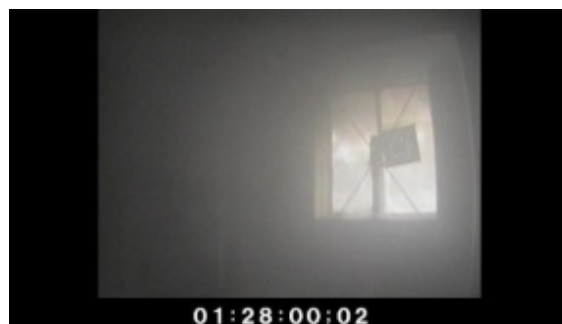
写真 4.7.2-27 ガラス破損後に流入する煙
