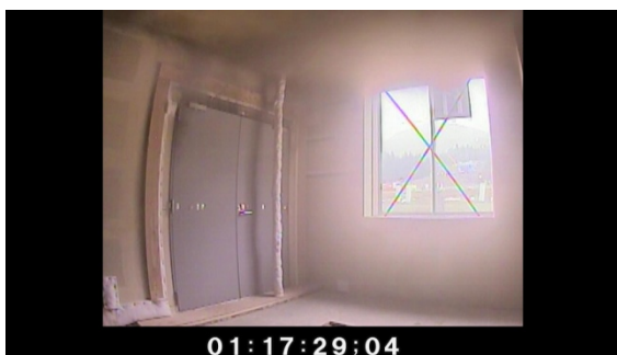
写真 4.7.2-24 防火戸から侵入する煙
