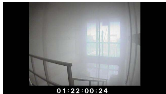
写真 4.7.2-23 階段室3階の見通し
