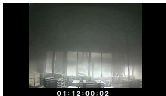
写真 4.7.2-17 床近くまで降下した煙
