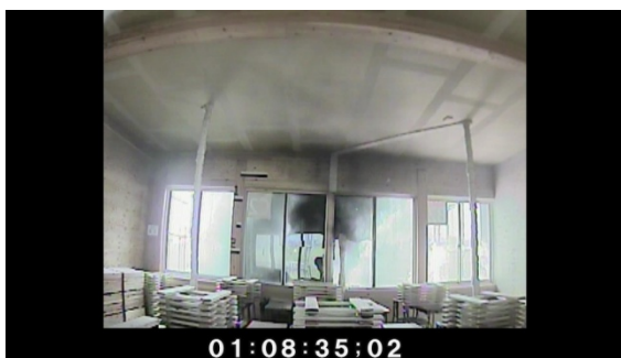
写真 4.7.2-16 割れた窓から流入する煙
