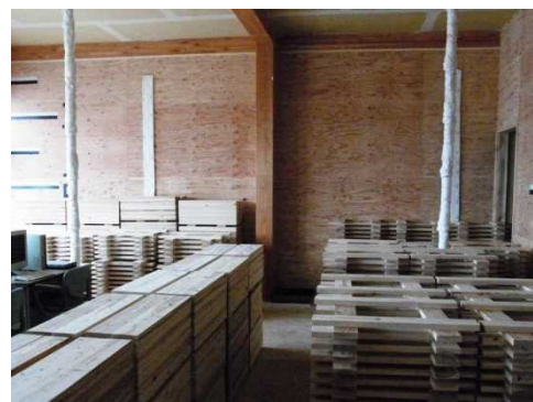
写真 4.4.4-2 実験前のクリブ設置の様子
