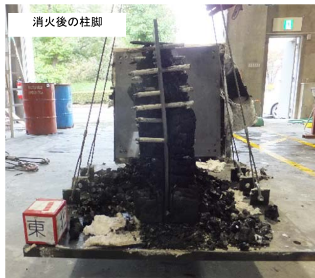
写真 4.7.3-3 柱試験体（ピン - 柱脚固定支持）加熱前・加熱中・加熱後の様子
