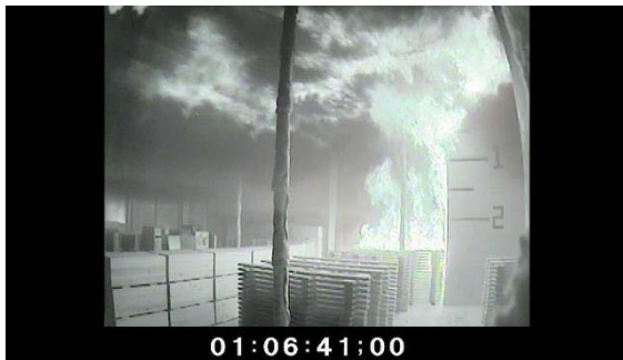
写真 4.7.2-8 天井下を延びる火炎
