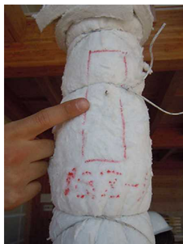
写真 2.5.3-2 熱電対設置の様子
