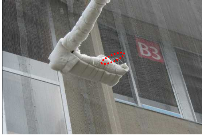
写真 4.5.4-4 熱流束計および屋外雰囲気温度測定用シース熱電対の設置状況
