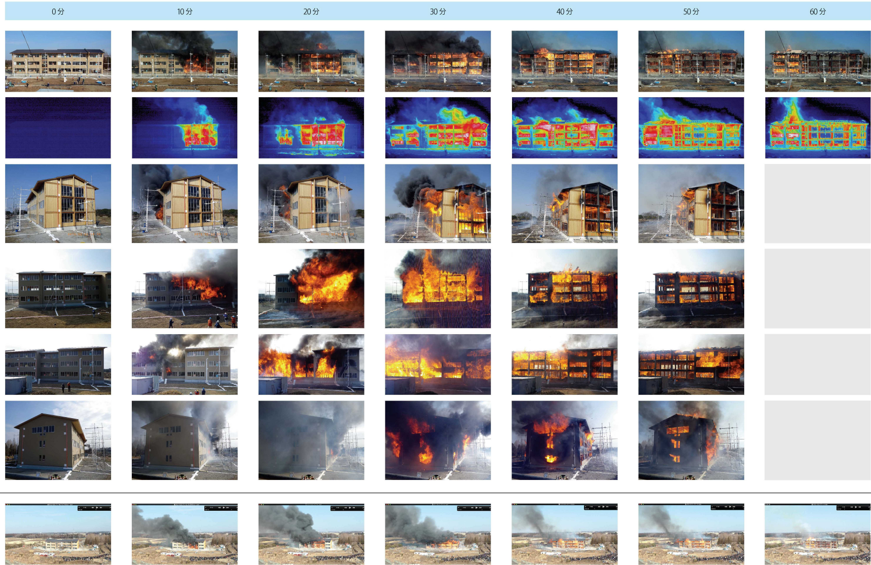
図 2.7.2-4 火災進展の状況 1 (点火後 0 分～60 分)
