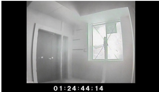
写真 4.7.2-26 ガラス破損時点
