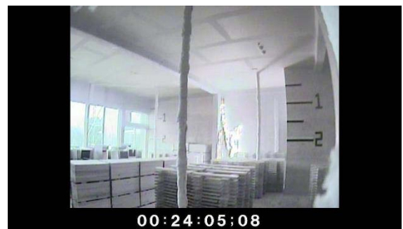
写真 4.7.2-5 天井付近に達した火炎
