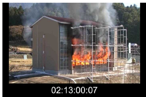
写真 3.7.2-17 3階バルコニーへの着火
