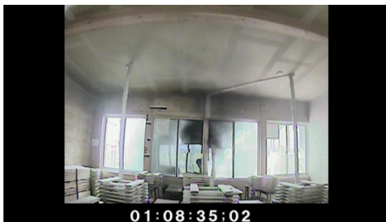
写真 4.7.2-16 割れた窓から流入する煙
