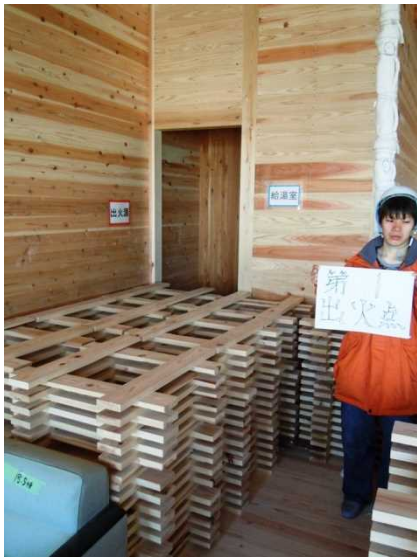
写真 2.4.3-1 実験前の火源周辺の様子
