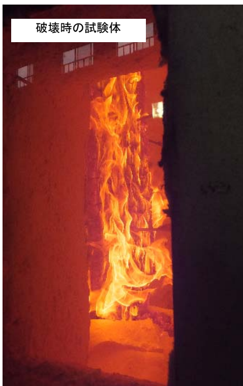
写真 4.7.3-3 柱試験体（ピン - 柱脚固定支持）加熱前・加熱中・加熱後の様子
