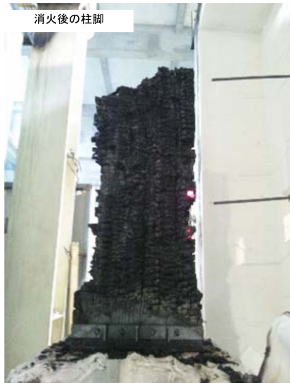
写真 4.7.3-2 柱試験体（両端ピン支持）加熱前・加熱中・加熱後の様子
