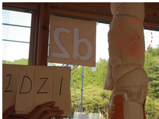
写真 4.5.3-2 熱電対設置の様子
