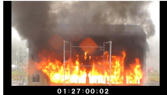
写真 4.7.2-25 北側防火壁を越えた火炎
