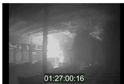
写真 3.7.2-7 出火室全体への延焼
