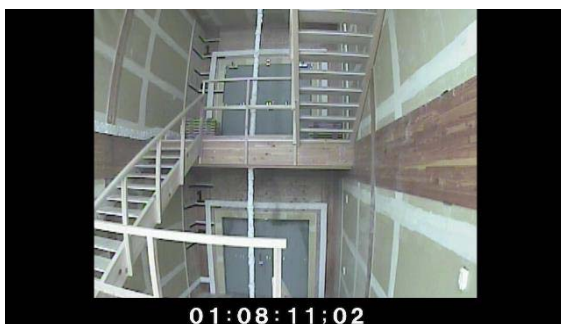
写真 4.7.2-22 1階防火戸から侵入する煙
