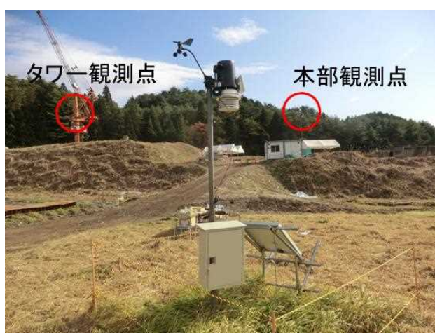
写真 4.5.1-1 気象観測装置（実験建物観測点）
