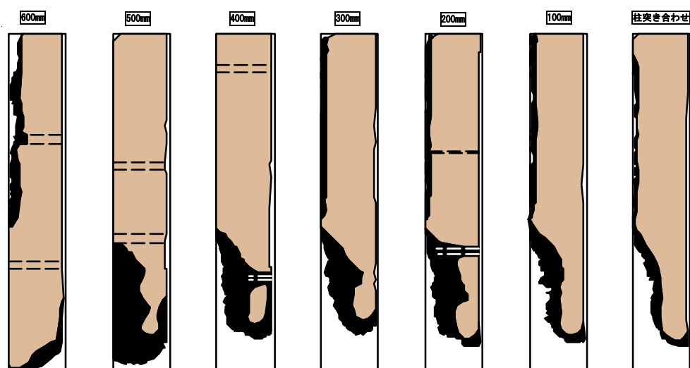
図 4.7.7-9 梁 1J6（南側）の炭化状況
