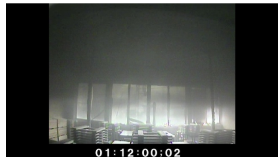
写真 4.7.2-17 床近くまで降下した煙
