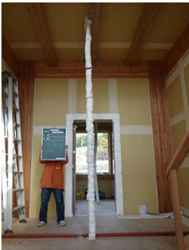
写真 3.5.3-1 熱電対タワー
