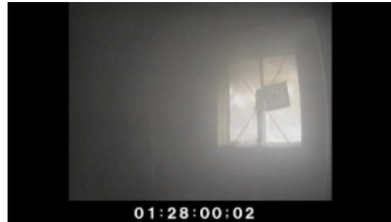
写真 4.7.2-27 ガラス破損後に流入する煙
