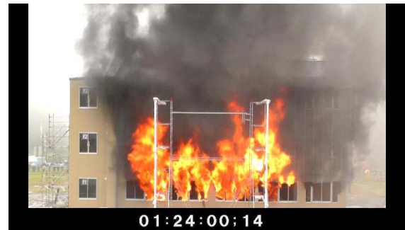
写真 4.7.2-15 北側3階に達した噴出火炎
