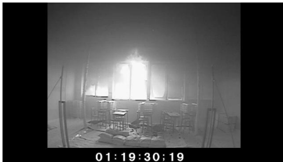
写真 4.7.2-20 室内に侵入する火炎
