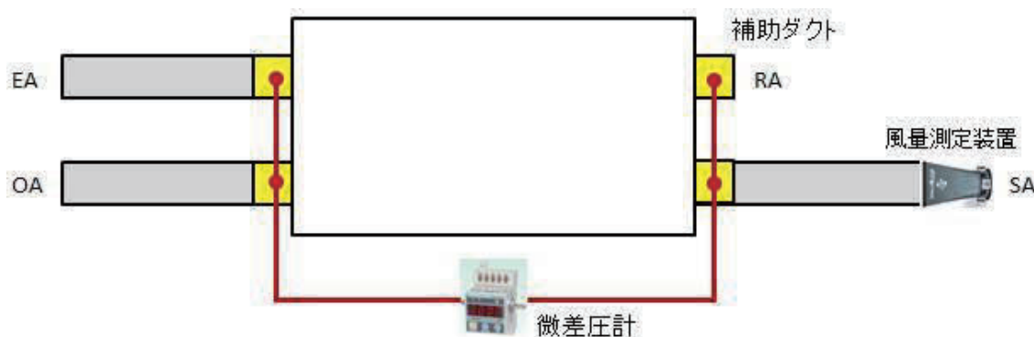
図 200 微差圧計設置、風量計測
