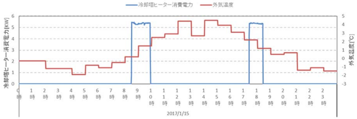
図 4-3.50 ID01 : 2017 年 1 月 15 日の冷却塔ヒーターの時刻別消費電力及び外気温度
