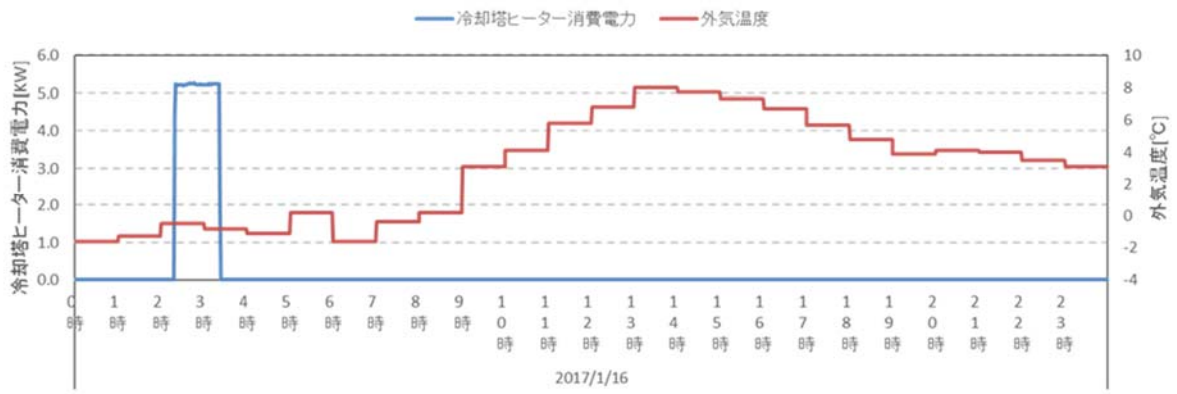
図 4-3.51 ID01 : 2017 年 1 月 16 日の冷却塔ヒーターの時刻別消費電力及び外気温度
