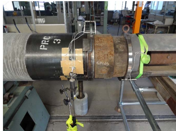
(b) 試験体と油圧ジャッキの接合状況
