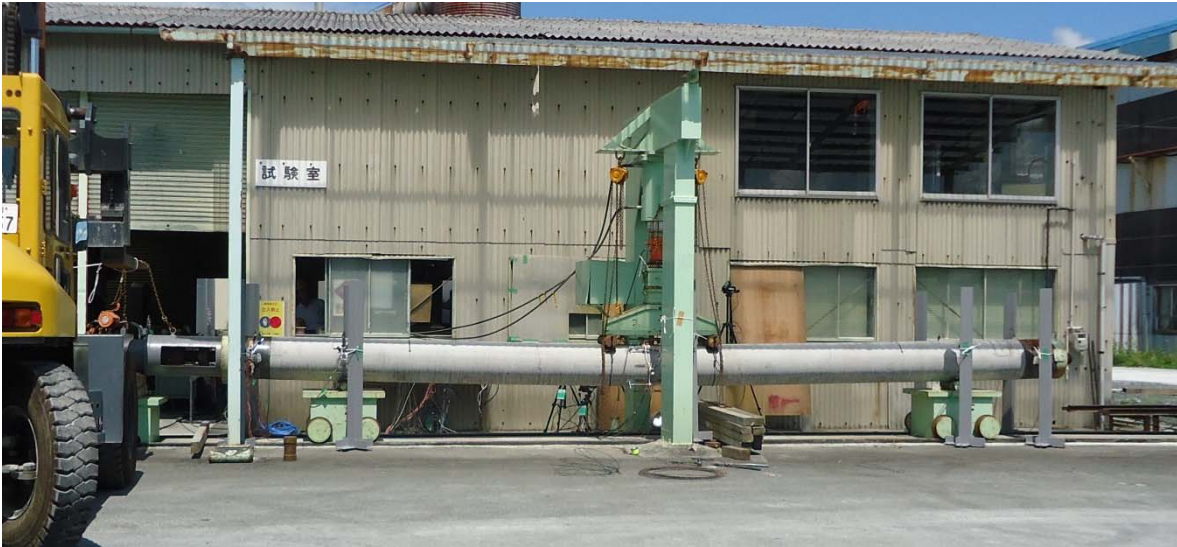
図 2.3.12 載荷状況（ロッドによる軸力導入 PRC_I_2_U ①）
