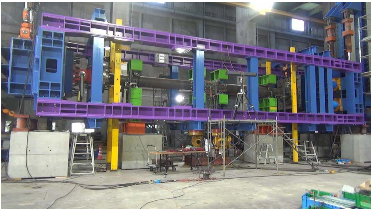
図 2.3.8 加力装置 (反カフレームによる軸力導入)
