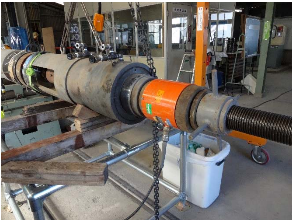
(a) 油圧ジャッキおよびロードセル
