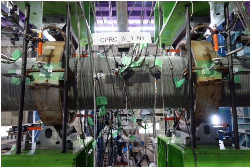
図 3.2.5 試験対象区間バンド取り付け状況
