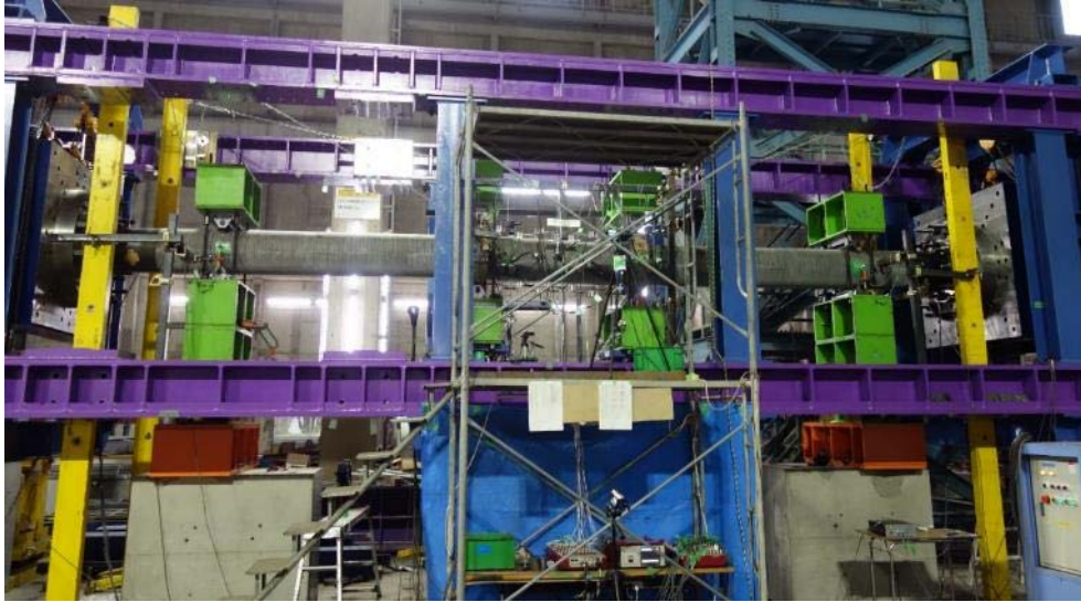
図 3.2.4 荷重装置および試験体の取り付け部
