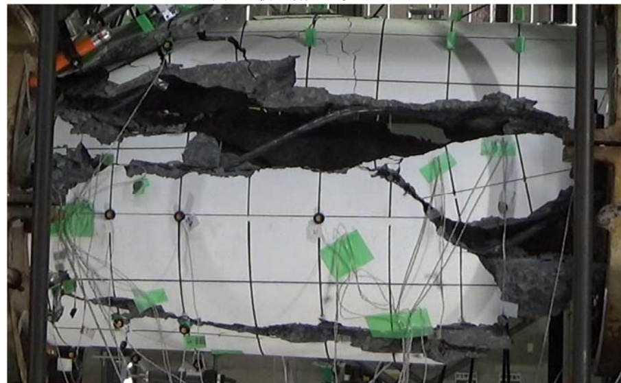
(c) 最終破壊状況 (西面)
