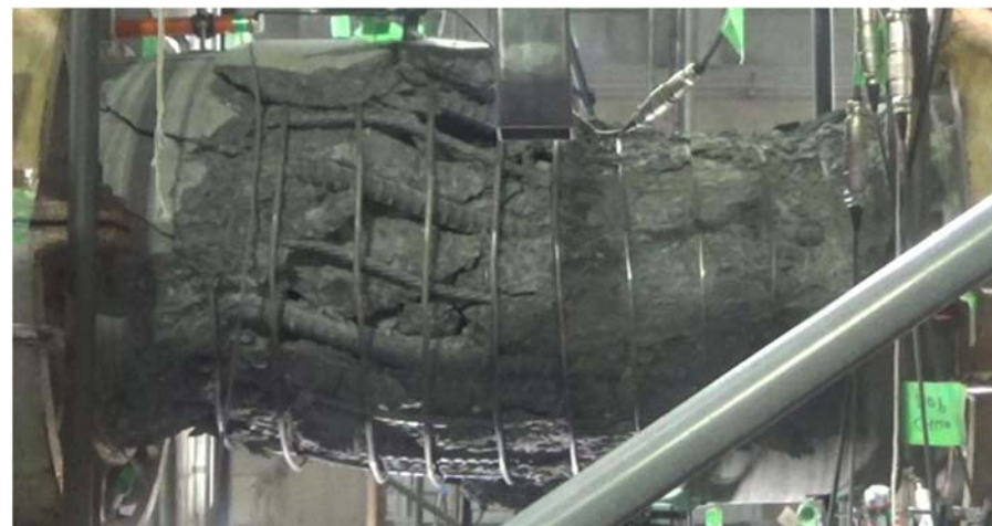
(f) 最終破壊状況（東面）
