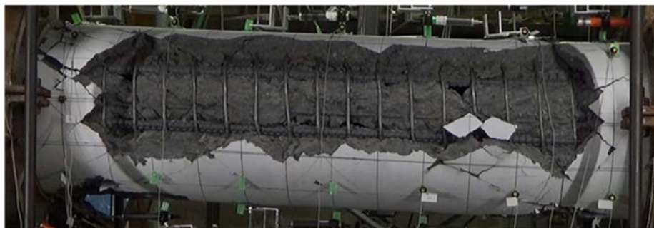
(c) 最終破壊状況 (西面)
