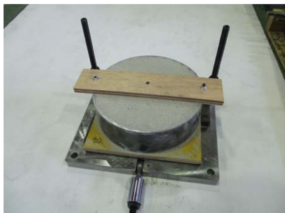
写真 2.3.2.1 垂直穿孔治具供試体セット状況
