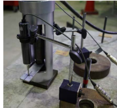
図 2.2.3.1-2 引抜き試験の加力装置および変位計測状況
