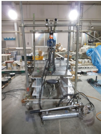
写真 2.2.2.1-5 荷重試験装置（異形鉄筋）
