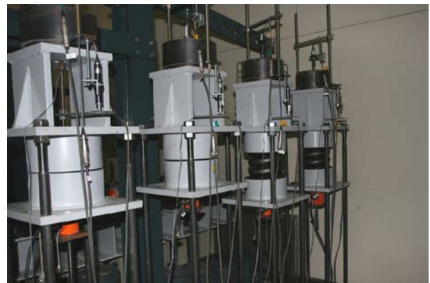
写真 2.2.2.1-8 クリープ試験状況
