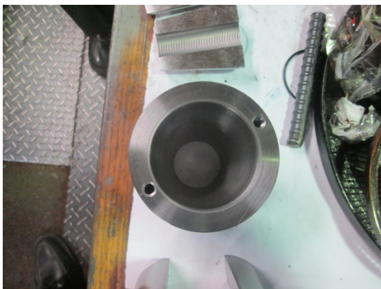
写真 2.2.2.1-7 異形鉄筋用のチャック
