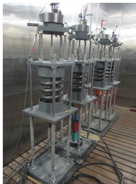
写真 2.3.2.3 短期クリープ試験の状況
