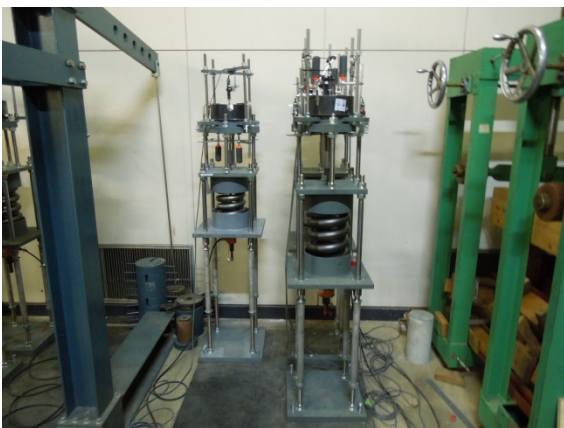
写真 2.2.2.3-3 クリープ試験実施状況 (20℃)
