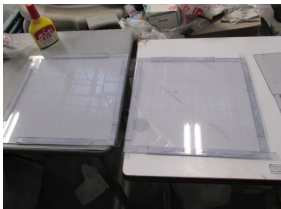
写真 3.7.1 樹脂板製作用型枠
