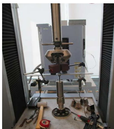
解図2 接着力試験の実施状況
