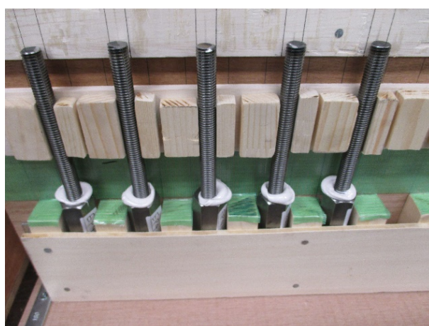
解図 1 接着試験体製作用治具の例
