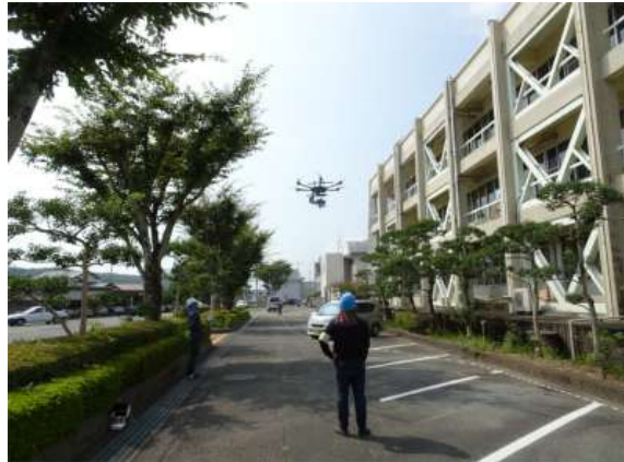
写真 8.4.3.5 オルソ撮影の様子
