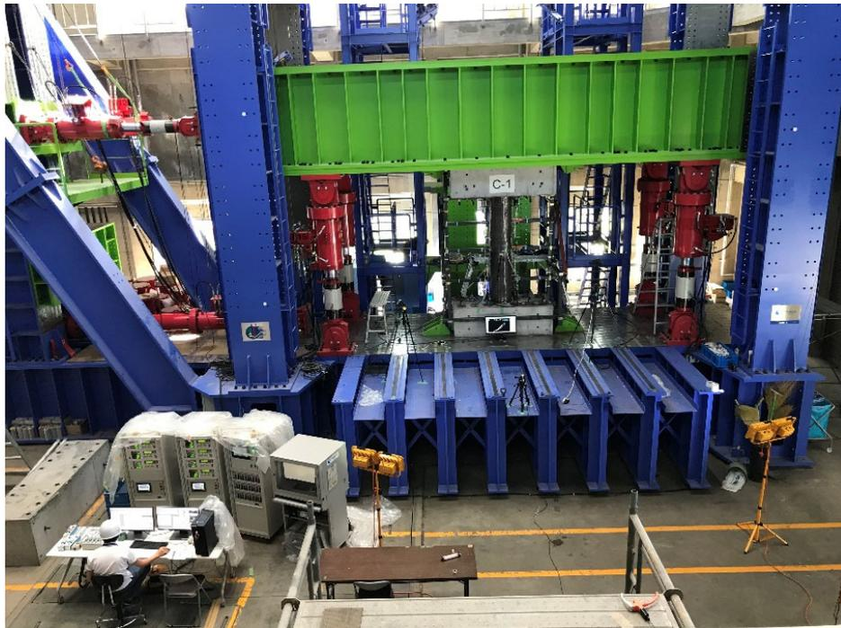
図 1.3.2-1 曲げせん断載荷実験概要
