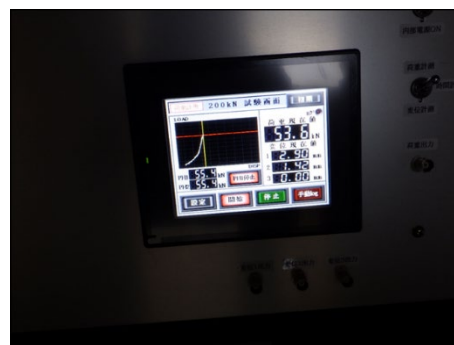
写真 8.3.2-14 あと施工アンカー施工 後試験，引張試験結果（ 第三者機関による確認） (実測荷重 55.4kN)
