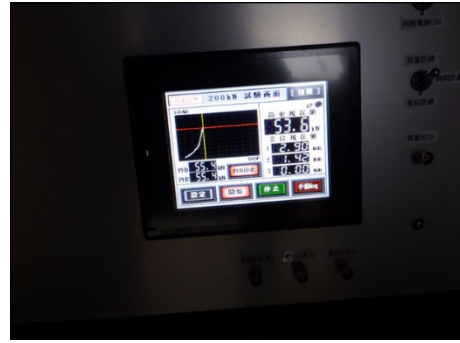
写真 8.3.2-18 あと施工アンカー施工 後試験，引張試験結果 (第三者機関による確認) (実測荷重 55.4kN)
