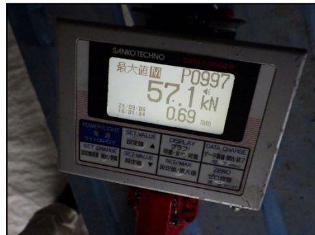
写真 8.3.2-20 あと施工アンカー施工 後試験，上向き引張試験結果 (第三者機関による確認) (実測荷重 57.1kN，変位 0.69mm)
