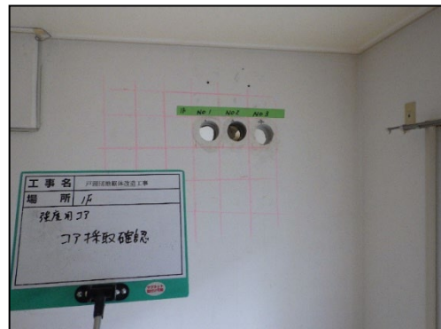
写真 8.2.2-5 強度試験用コア採取後 (1階戸境壁)
