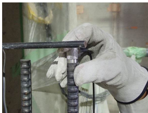
写真 8.3.1-11 探触子保持状況
