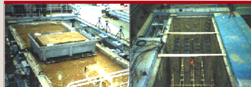
写真7:大型せん断土槽(建設省建築研究所内)
