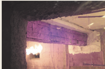
炉内で加熱中のはり試験体
