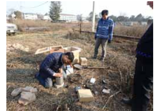
■写真3 ネパールで実施した微動探査の様子
