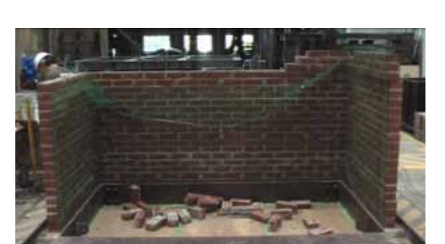
■写真8 振動実験後の試験体
