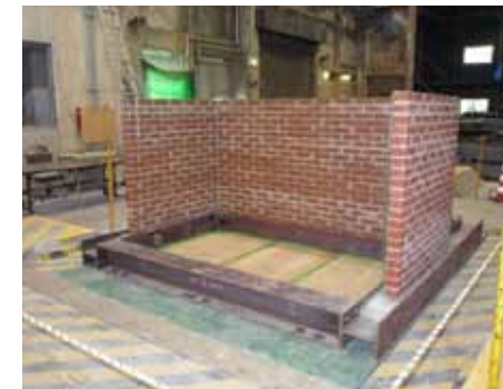
■写真7 組積造試験体の振動実験(加力前)
