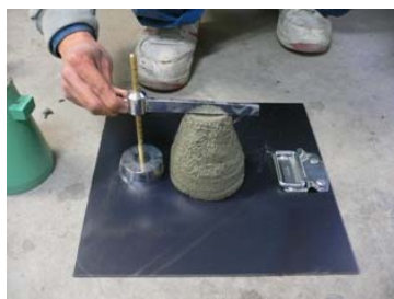
写真-5.12 スランプ試験
