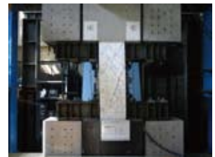
写真 2 梁せいを低減させた梁の加力試験状況
