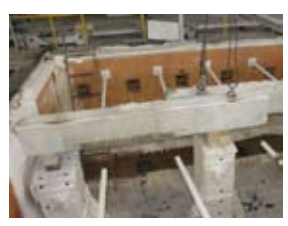
写真 1 PCM補修部材の耐火試験状況
