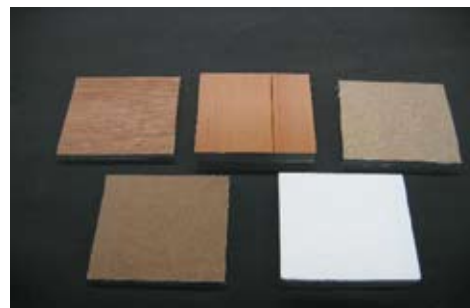
図1 各種建築材料試験体 (左上から、合板、フローリング、パーティクルボード、MDF、EPS)
