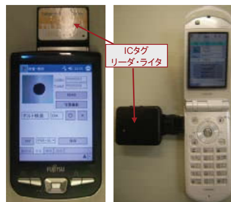
図 4 施工現場で使用するツール
