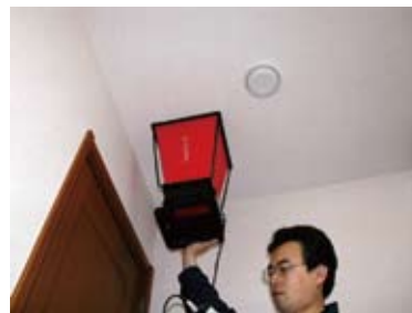
図6 風量測定事例(フード式風量計)
