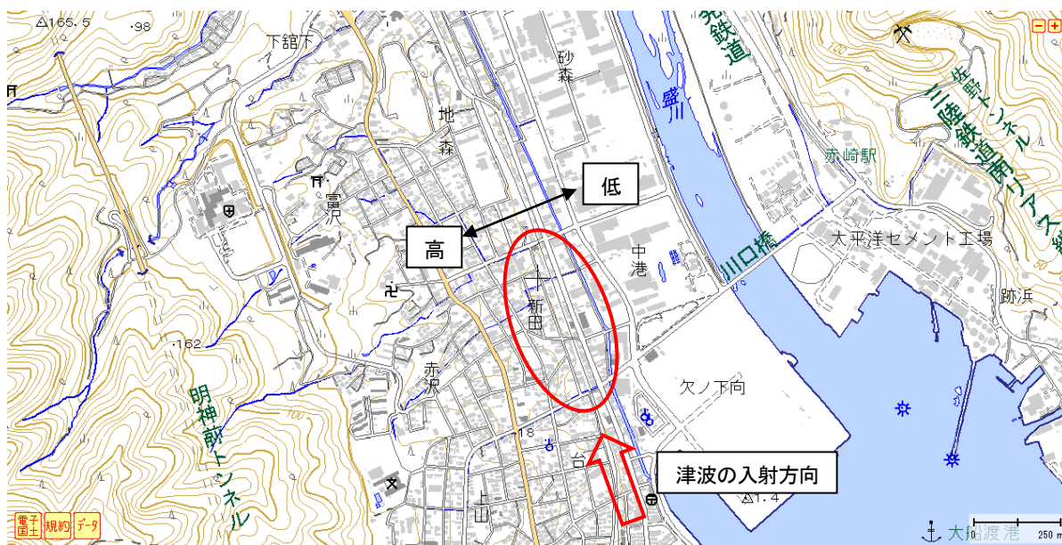
図 C-8.2 大船渡市新田の地形と津波の入射方向（等高線 1 本が 10m）
