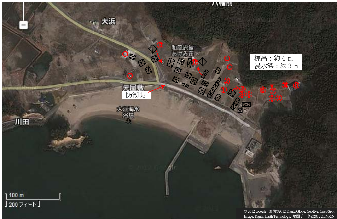
図 C-20.1 東松島市宮戸島大浜地区の航空写真 (⊠：流失した建築物、○：残存する建築物)
