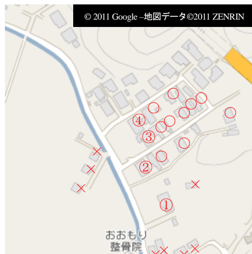
図 C-2.3 大槌町第 24 地割南東部の残存・流失建築物の分布 (○, 丸数字 : 残存建築物、× : 流失建築物、無印は未調査)
