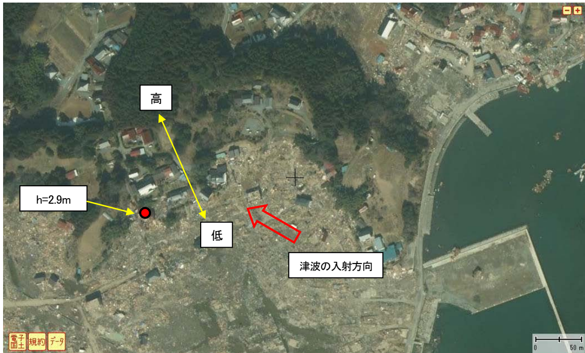
図 C-16.2 気仙沼市松崎片浜の調査建物（図中の h は痕跡から推定した浸水深）
