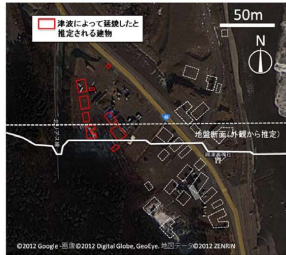
図 7.3-2 岩手県野田村の津波火災現場周辺図 (写真 7.3-1 の白枠内)
