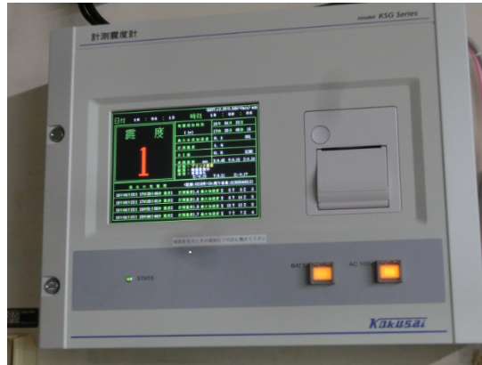
写真 5.6.2 益城町の計測震度計の記録盤
