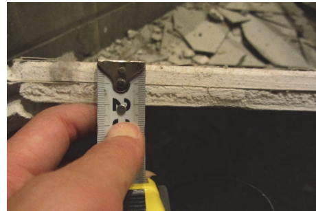
(l) 2階客席に落ちた天井板(せっこうボード(厚さ9.5mm)×2枚)
