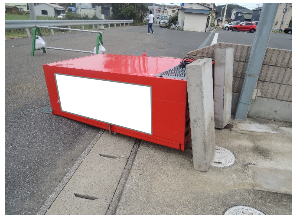
写真 4.2.14 自動販売機の転倒
