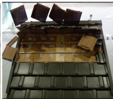
F型瓦の飛散実験の状況
