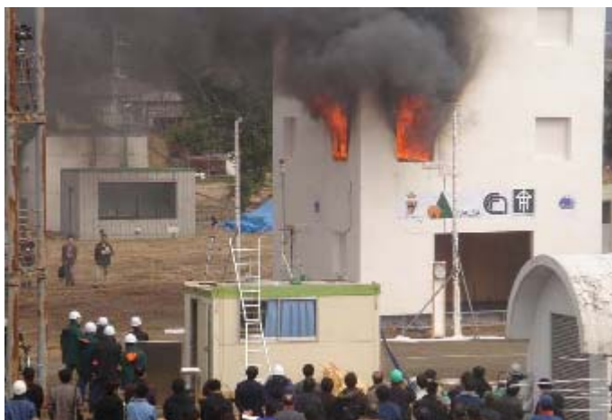
写真一1. 2. 1. 4 イタリア国立樹木・木材研究所との共同研究による実大火災実験
