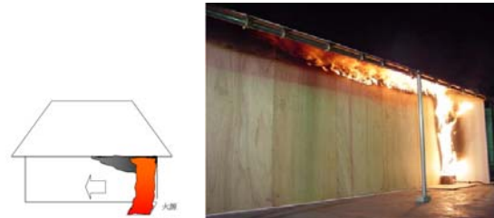
図5 木材をはった外壁の水平火災伝搬実験
