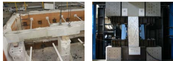
写真1 PCM 補修部材の耐火試験状況
