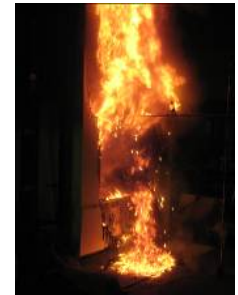
図 9 EPS 試験体の燃焼性状
