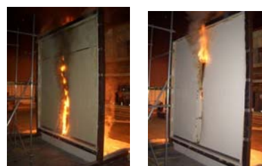
図3 アルミ製間仕切り壁の加熱実験
