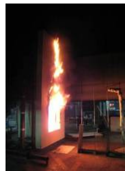
図 8 外断熱工法試験体の燃焼性状
