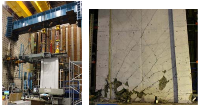
写真1 耐力壁の構造実験
