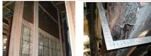
図3 伝統的木造木舞土塗り真壁造外壁準耐火構造仕様の開発
