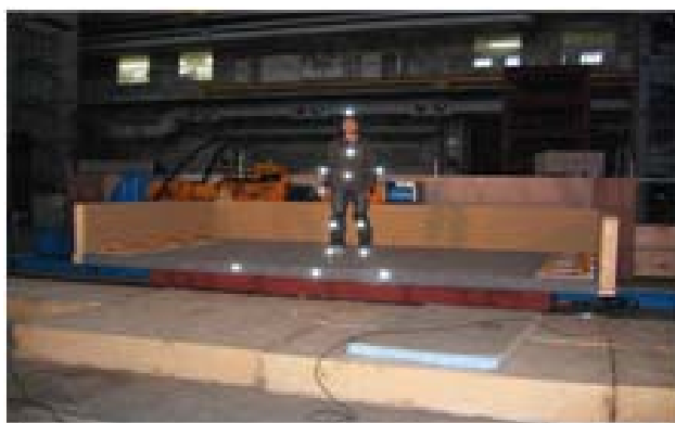
写真一1. 1. 2. 1 長周期地震動を再現できる大ストローク振動台(建築研究所内)
