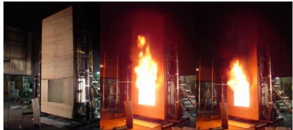
図6 木材をはった外壁の上方火災伝搬実験
