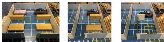
図6 介護ロボット（離床支援ロボット）を用いた様々な居室からの介助避難実験
