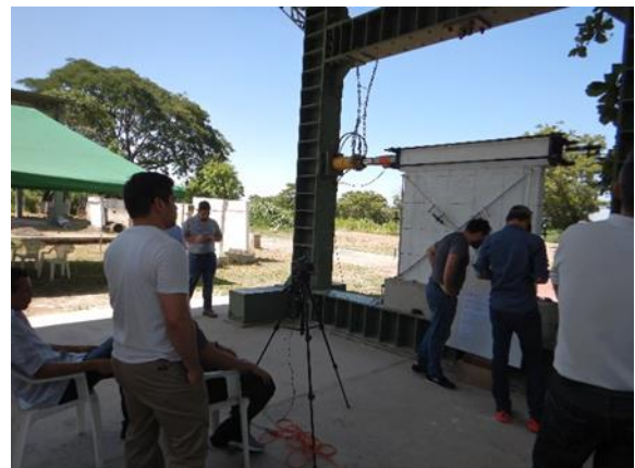
写真-I-2. 1. 7 枠組組積造壁の水平載荷実験の様子
