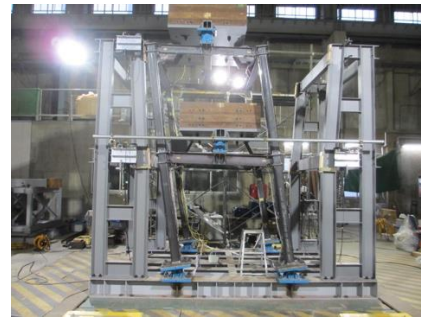
写真1 2層骨組の振動台実験（加振後）
