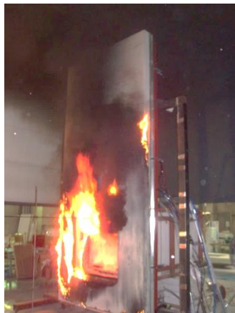
建物の内装材・外装材の燃焼実験
