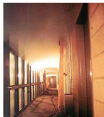
廊下を使った煙の流動実験
