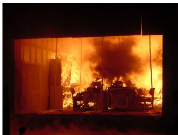
事務室を再現した火災実験
