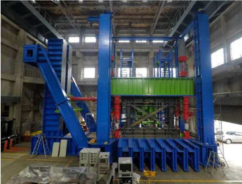
試験装置正面（面内水平1台，鉛直ジャッキ4台）
