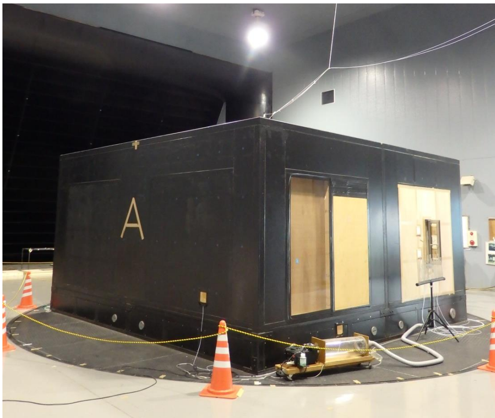
ターンテーブル上に試験体を設置した状態
