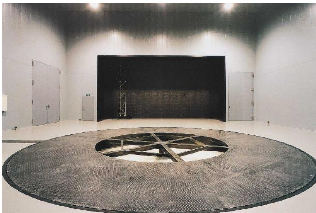
通風実験棟内部写真(風洞の吹き出し口(奥)と測定部のターンテーブル)
